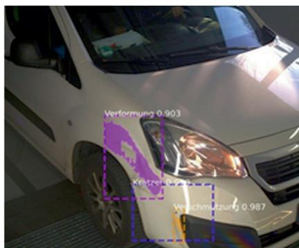
Bild 2. Segmentiertes Fahrzeug (links), erkannte Beschädigungen (rechts). © Quelle: TwoTronic GmbH und Fraunhofer IPA
